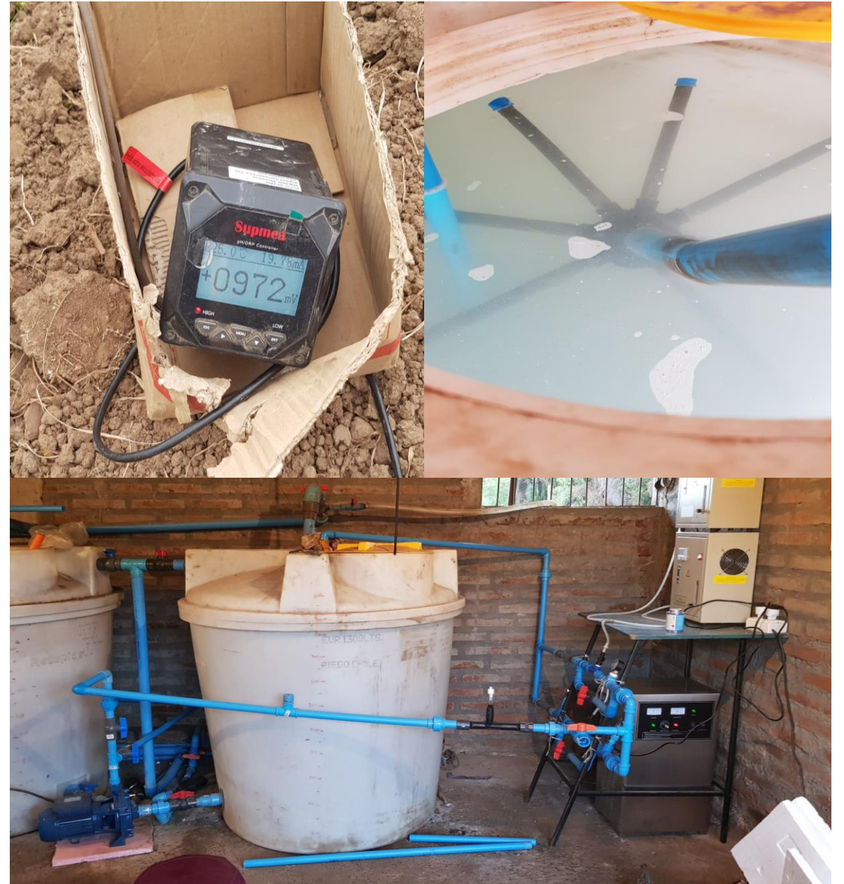
Fuente: Sistema de ozono acuoso y medidor ORP, imagen propia.
