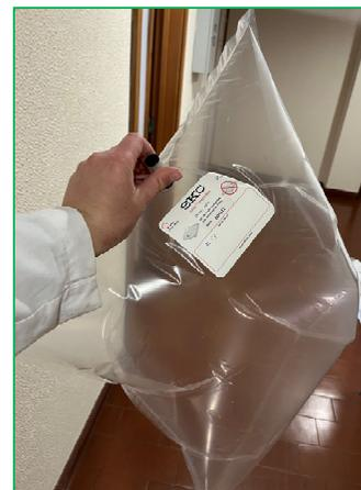
Figura 6. Bolsa FTIR para muestra en fase gaseosa
