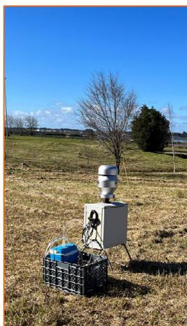
Figura 2. Captador MCV con cabezal de PM10
